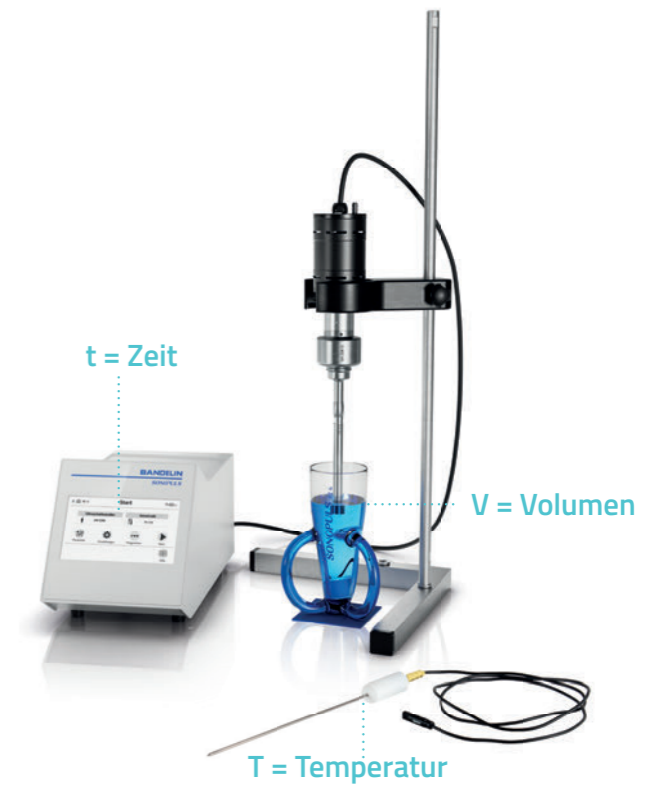
Darstellung des Versuchsaufbaus einer kalorimetrischen Messung zur Leistungsbestimmung
